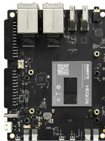
QCS8550 开发套件是一款基于高通 QCS8550 为平台的高算力开发套件,采用 4nm 制程,集成了 Android 系统。QCS8550 算力高达 48 Tops,可兼容 QCS8250 和 SM8475,拥有强大的图形处理能力和视频编解码能力,以及丰富的外围接口。
